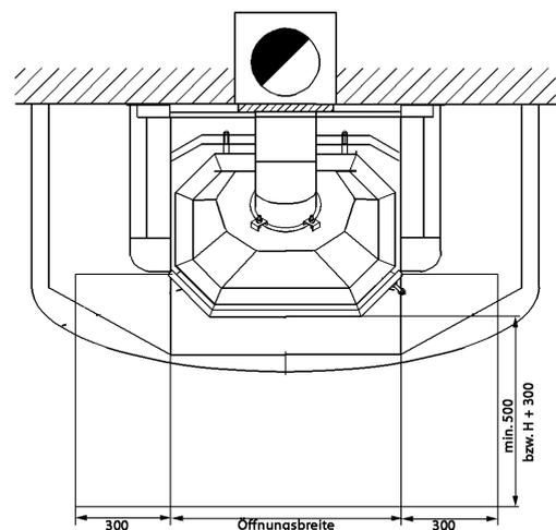
Vor dem Heizeinsatz muß der Fußboden aus brennbaren Materialien durch einen ausreichend dicken Belag aus nicht brennbaren Baustoffen geschützt oder ersetzt werden. Dabei betragen die
